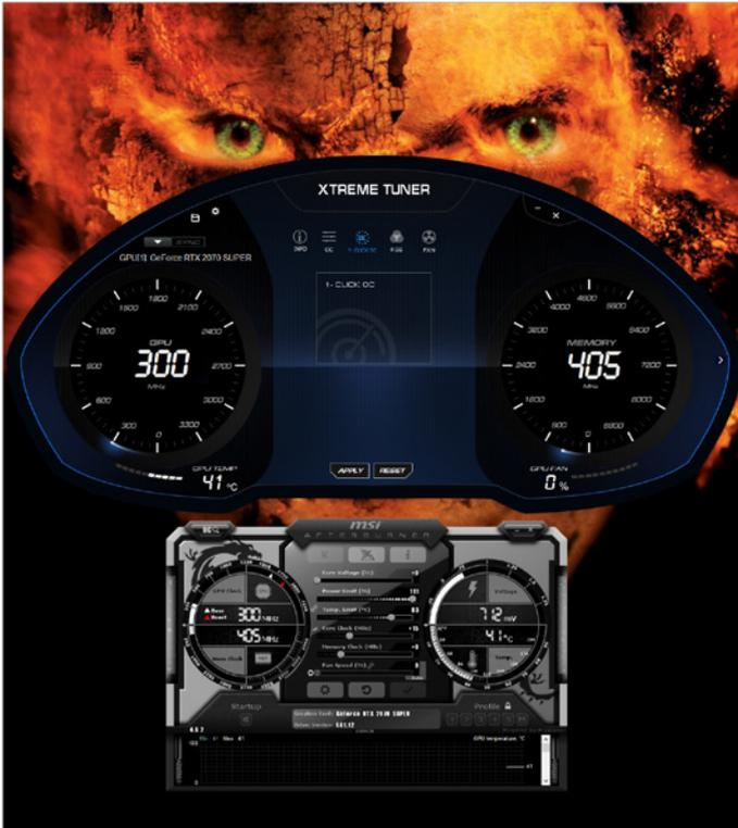
KFA2: Aktivieren Sie das „1-Click OC“ im Xtreme-Tuner-Tool, wird nicht nur der GPU-Boost der RTX 2070S EX um 15 MHz erhöht, sondern auch das Powerlimit auf das Maximum von 111 Prozent (240 Watt) gesetzt, wie der Afterburner offenbart.
