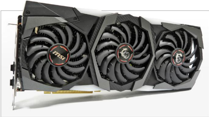
MSI führt neben der getesteten Gaming X auch eine Gaming X Trio zum Aufpreis von circa 20 Euro. Sie bietet eine noch größere Kühlfläche, einen Extralüfter sowie einen minimal höheren GPU-Boost – aber wie gehabt nur 215 Watt TDP (240 maximal).
